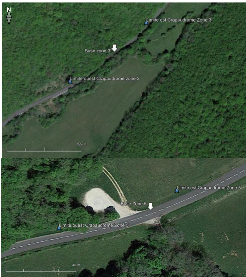
Figure 27 Emplacements des buses pouvant faire office de crapauduc et proposition des limites des crapaudromes sur les zones prioritaires 3 et 5 en fonction de la configuration terrain. RD7, Côte d'Or.
